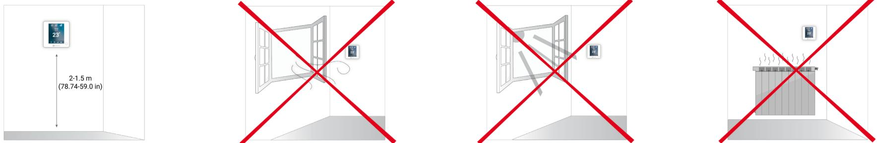
(ES) La altura del termostato no debe ser superior a 2 m con respecto del suelo. (EN) The height of the thermostat must not be more than 2 m from the ground. (FR) La distance entre le thermostat et le sol ne doit pas excéder 2 mètres. (IT) L'altezza del termostato non deve superare i 2 m dal pavimento. (DE) Die Höhe des Thermostats darf nicht mehr als 2 m über dem Boden liegen.
