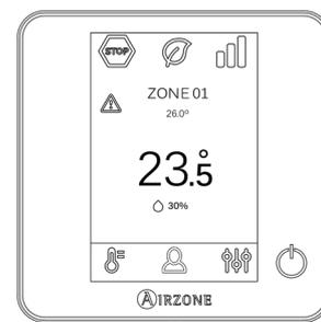
Pour la remplacer, retirez le thermostat de son support et introduisez la nouvelle pile (CR2450) (Fig. 60).
