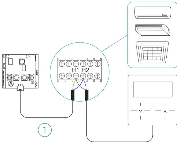
(ES) Se requiere un control cableado XK46 o equivalente.
