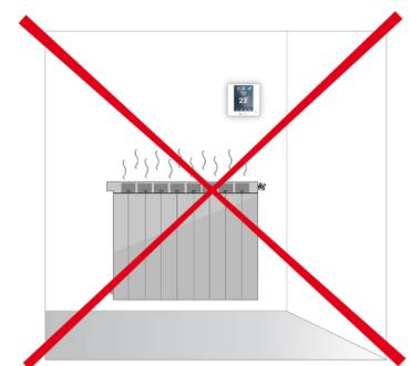
(ES) La altura del termostato no debe ser superior a 2 m con respecto del suelo. (EN) The height of the thermostat must not be more than 2 m from the ground. (FR) La distance entre le thermostat et le sol ne doit pas excéder 2 mètres. (IT) L'altezza del termostato non deve superare i 2 m dal pavimento. (DE) Die Höhe des Thermostats darf nicht mehr als 2 m über dem Boden liegen.
