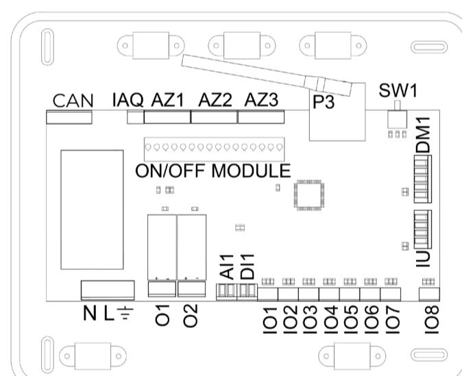
(ES) No conectar motores directamente a las bornas IO1..IO8 / (EN) Do not connect actuators directly to terminals IO1..IO8 / (PT) Não ligar motores diretamente aos bornes IO1..IO8 / (FR) Ne pas connecter de moteurs directement aux bornes IO1..IO8 / (IT) Non collegare i motori direttamente ai morsetti IO1..IO8 / (DE) Antriebe nicht direkt an den Klemmen IO1..IO8 anschließen
