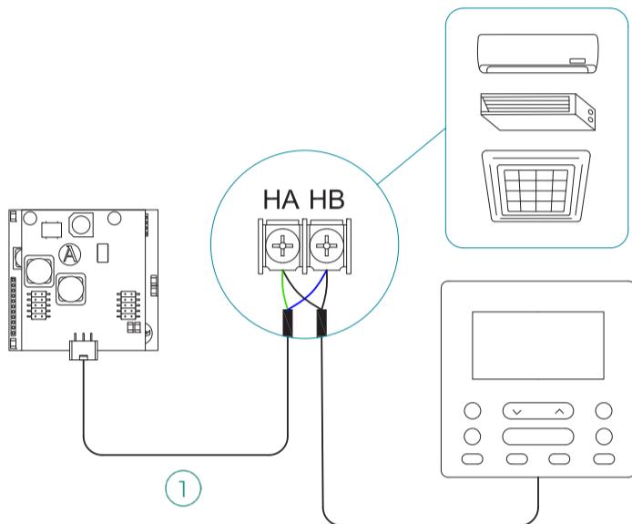
(ES) El único control cableado del fabricante compatible es el KJR-120X o equivalente.
