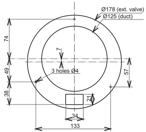
**Fonctionnement:** Bouche d'extraction assurant un débit permanent quand la bouche est hors alimentation et un débit plus important quand est sous tension 230V.
