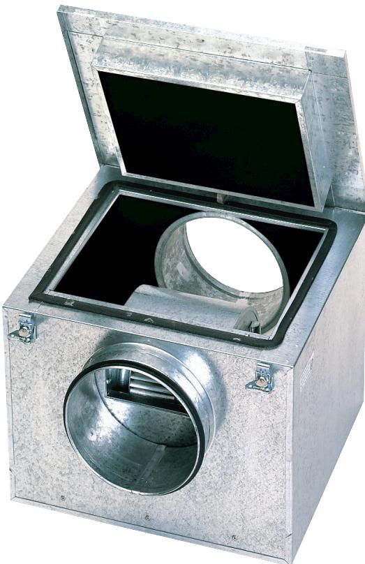
Caissons acoustiques d'extraction et d'insufflation fabriqués en tôle d'acier galvanisé avec isolation acoustique en laine de verre ininflammable de 50 mm M0. Ouverture facile du panneau supérieur. Installation en combles ou en terrasse. Température de fonctionnement de -20°C à +40°C.
