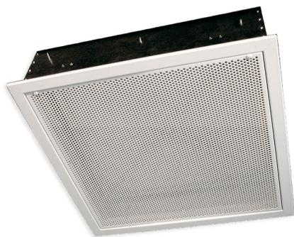
Les DATI/DATP sont des diffuseurs carrés avec une façade ouvrable en tôle perforée blanche fixée par charnières et un plénum en acier galvanisé à raccordement circulaire vertical.
