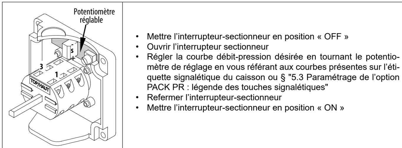
Remarque : entre la position « 0 » et la position « 1 » du potentiomètre de réglage, le moteur est à l'arrêt.
