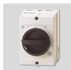
COM D/S Commutateur \Delta / \Delta Permet d'obtenir une seconde vitesse quand il est raccordé à un moteur 3~400 ou 3~400/690, 1 vitesse, acceptant la variation de tension et raccordé à un réseau 3~400V.
