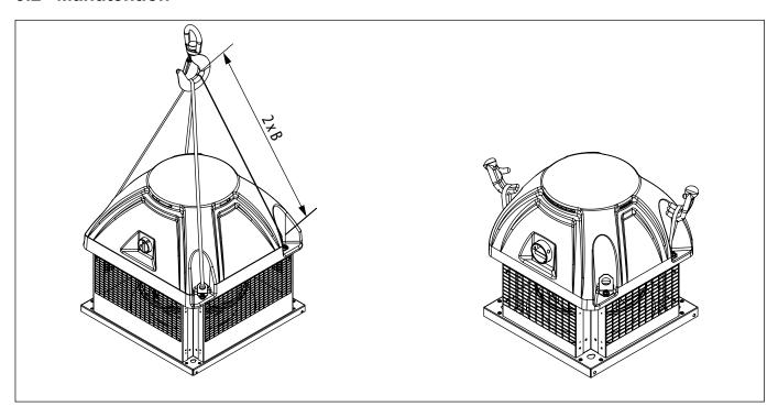
Afin d'éviter de mettre en danger les personnes ou d'endommager le matériel, utiliser des appareils de manutention conformes et en bon état. Lever impérativement la tourelle par les 4 pattes de levage.
