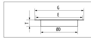
La plaque d'adaptation permet de raccorder la tourelle à un conduit circulaire. Il s'agit d'une pièce permettant le raccordement aéraulique, elle n'est pas prévu pour supporter le poids de la tourelle. Elle est incompatible avec l'utilisation du volet d'économie d'énergie AJCA et de la costière acoustique.
