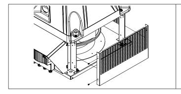
Démonter la grille en dévissant les vis autoforantes Ø4,2 (clé de 8).
