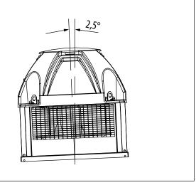
L'embase de la tourelle doit recouvrir entièrement le support pour assurer une bonne étanchéité. S'assurer que le support soit adapté au poids de l'ensemble de la machine et de ses différents accessoires. Fixer la tourelle par les trous Ø20 prévus à cet effet. L'utilisation de rondelle LL est recommandée.
