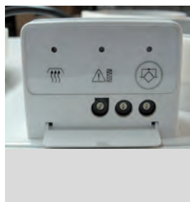
Potenciomètre de réglage, bouton M/A by-pass et visualisation Leds état filtre et dégivrage
