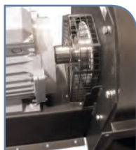
Turbine de réfrigération
