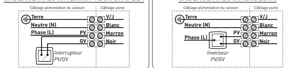
Selon la Norme NFC15-100 sur les installations électriques, votre alimentation doit être une gaine annelée Ø 20mm type ICTA, ou un câble 3G avec des fils de section 1,5 à 2,5 mm<sup>2</sup>.
