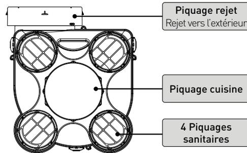
Les 4 piquages sanitaires sont déclipables par ¼ de tour, pour faciliter le raccordement des gaines.
