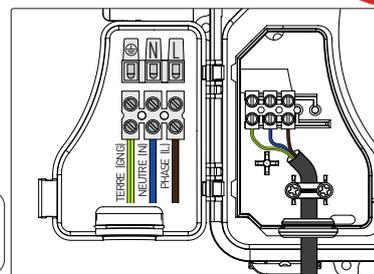
Selon la Norme NF C15-100 sur les installations électriques, votre alimentation doit être une gaine annelée Ø 20mm type ICTA, ou un câble 3G avec des fils de section 1,5 à 2,5 mm².
