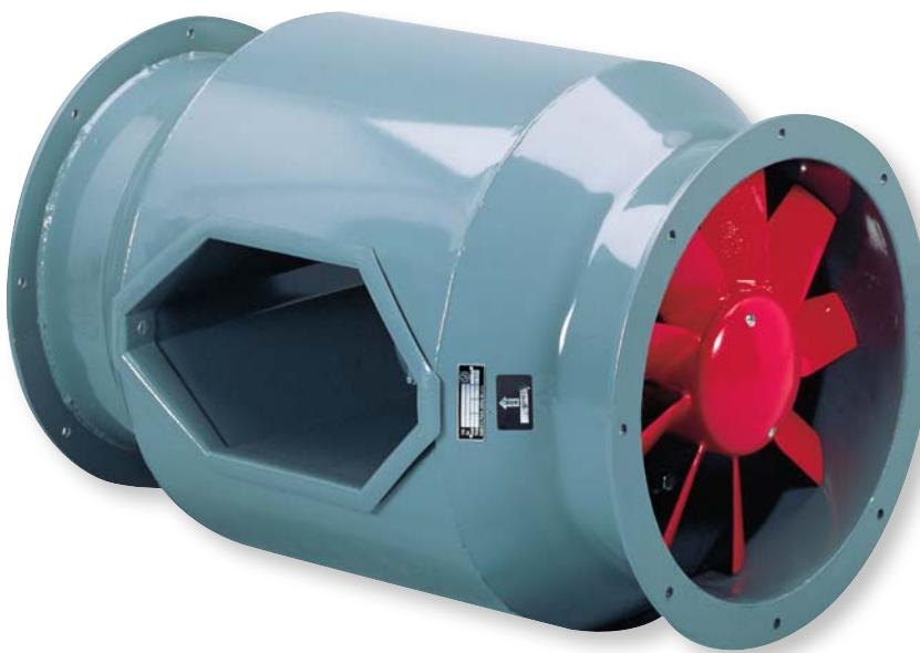
Ventilateurs axiaux tubulaires pour extraction gaz chauds. Ventilateur de type bifurqué avec le moteur en dehors du flux d'air. Virole en tôle d'acier de type bifurqué (une cheminée traverse de part en part la virole assurant la protection et le refroidissement du moteur).
