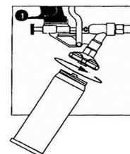
Fig.2 - Le flux de matière se règle à l'arrière du pistolet. Pour un flux restreint et/ou une couche mince, tourner la vis de réglage dans le sens des aiguilles d'une montre. Pour augmenter le flux et/ou l'épaisseur de la couche, procéder en sens inverse. Un bon réglage est indispensable pour obtenir un résultat optimal.
