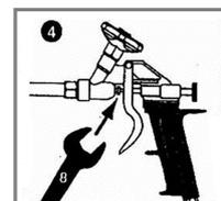
Fig.3 - Quand l'aérosol est vide, enlever le en le dévissant rapidement du pistolet. Nettoyer immédiatement l'adaptateur avec le Nettoyant spécial CRC PU Foam Cleaner (référence 32231). Visser le nettoyant sur l'adaptateur du pistolet. Pulvériser jusqu'à ce que le pistolet soit parfaitement propre. Il importe que l'adaptateur, la buse et l'embout de pulvérisation soient toujours parfaitement propres.
