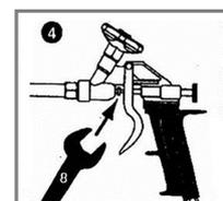
Le pistolet dispose d'un obturateur étanche à l'air évitant le dessèchement de la mousse après le vissage de l'aérosol.
