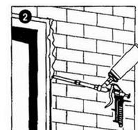
La pression sur le joint peut être augmentée en serrant la vis avec la clé N°8 dans le sens des aiguilles d'une montre.
