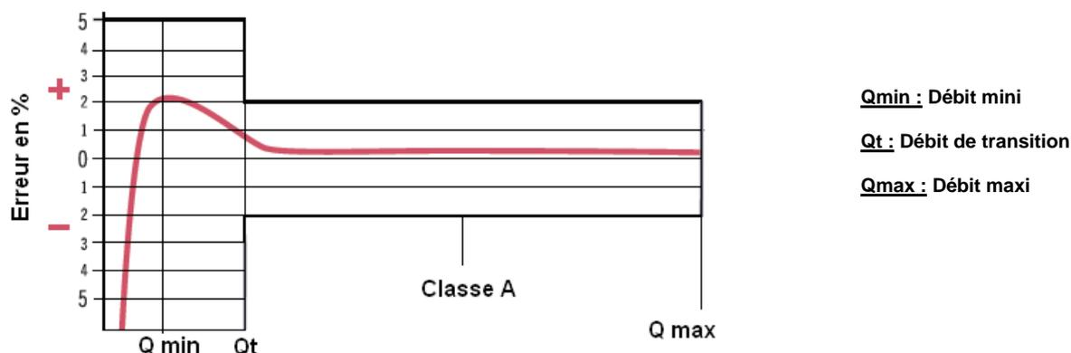
**COMPTEUR IRRIGATION A HELICE TANGENTIELLE A BRIDES PN10/16 EAU FROIDE CLASSE A**
