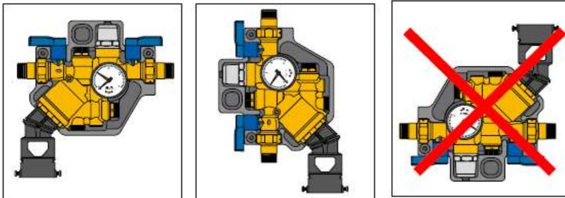
2. Le groupe est réglé normalement à une pression qui ne doit pas être inférieure à celle que l'on obtient en ajoutant 0,3 bar à la pression statique.
