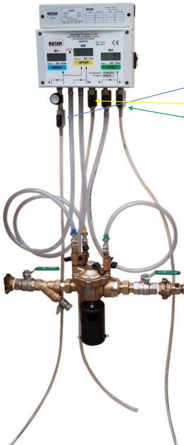
**Avant la mise sous pression, mettre sous tension l'appareil de contrôle**
