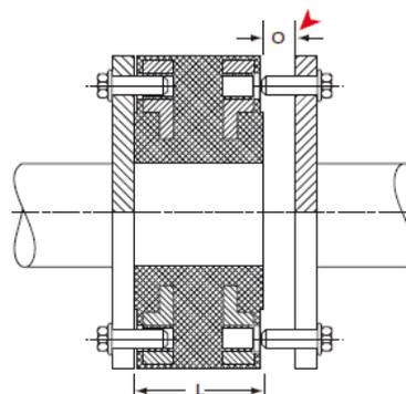
**O : Ne pas imposer de pression sur le connecteur pour combler l'espace réservé**
