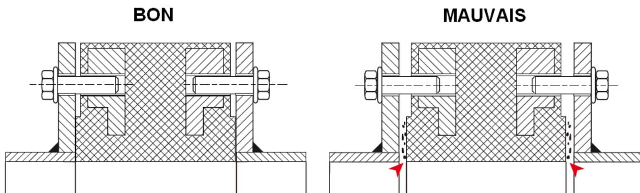
**Avant le montage du manchon, vérifier que les surfaces de contact soient propres et sans impuretés**
