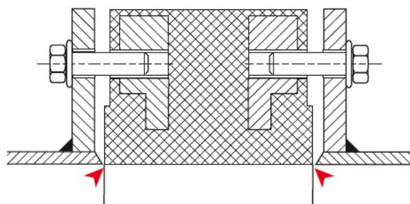
La surface de tube en contact avec le manchon doit être lisse afin d'éviter tout risque de déchirement
