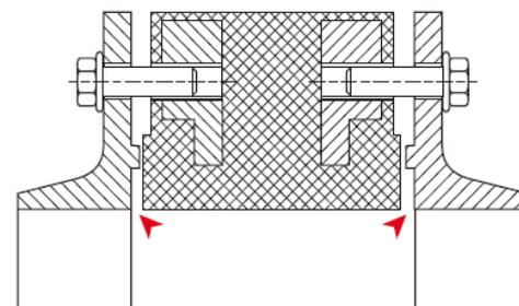
Le manchon doit être correctement en contact avec la surface de bride
