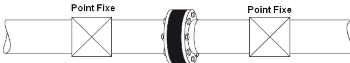
**Le manchon doit être installé entre 2 points fixes**
