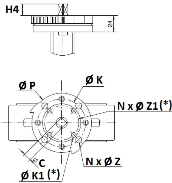
(\*) : Uniquement du DN32 au DN100 (voir montage avec platine F05 page suivante)
