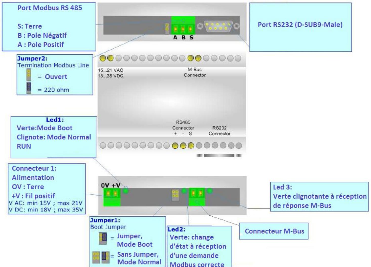
**CONVERTISSEUR MBUS FILAIRE-MODBUS JUSQU'À 20 COMPTEURS**
