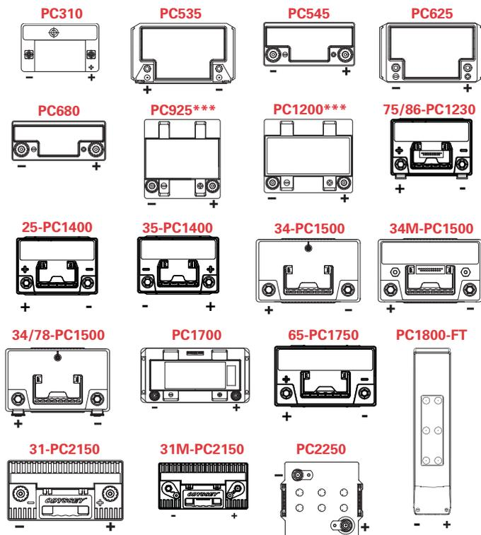
Schémas de la position des terminaux uniquement, non proportionnel aux dimensions
