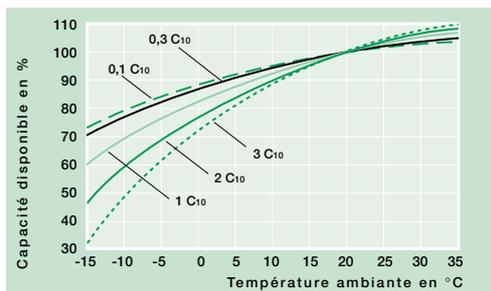
Capacité à différents régimes de décharge en fonction de la température.
