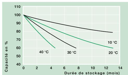
Autodécharge en fonction de la durée de stockage pour différentes températures.
