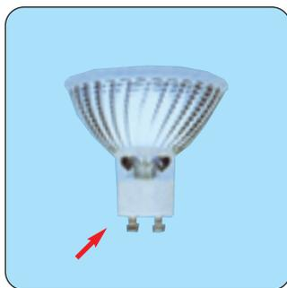
Bon à savoir : un culot GZ10 a des bords à angle droit (voir flèche rouge sur photo). Ce type de culot est uniquement monté sur les lampes munies d'un réflecteur dichroïque. Elles peuvent être placées sur des spots conçus et homologués pour supporter les fortes températures résultant du dégagement de 70 % de la chaleur par l'arrière de la lampe, (effet dichroïque).
