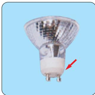
Bon à savoir : un culot GU10 a des bords biseautés à 45° (voir flèche rouge sur photo). Ce type de culot est uniquement monté sur les lampes munies d'un réflecteur aluminium. Elles doivent être placées sur des spots conçus et homologués seulement pour permettre un dégagement de la chaleur par l'avant (pas d'effet dichroïque).
