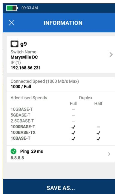
*Le test de port de commutateur indique le nom et l'adresse IP du commutateur, le port connecté et le réseau VLAN, ainsi que la vitesse annoncée et les paramètres de duplex. Si un test ping est configuré, l'adresse cible et le temps de réponse moyen sont affichés. Si vous défilez vers le bas, vous pouvez voir les résultats de la PoE.*
