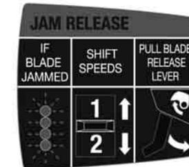
Když se řezné nože zaseknou, blikají všechny 4 LED diody. Posuvný spínač přesouvejte mezi 1 a 2 sem a tam a kvůli otevření řezných nožů stiskněte tlačítko spínače.
