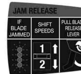
Ja griezējnaži saķeras, iedegas visas 4 gaismas diodes. Kustīgo slēdzi pārslēgt no pozīcijas 1 uz 2 un nospiegt slēdža pogu, lai atvērtu griezējnažus.
