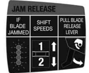
Hvis skæreknivene er klemt fast, så blinker alle 4 LED'er. Skub skydekontakten frem og tilbage mellem 1 og 2 og tryk på kontaktrykknappen for at åbne skæreknivene.
