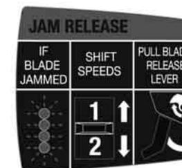
Ha a vágókések megszorultak, mind a 4 LED világít. Tolja a tolokapsolót az 1-es és a 2-es állás között ide-oda, és nyomja meg a nyomógombos kapsolót a vágókések nyitására.
