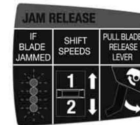
Ako su rezački noževi uklješteni, trepere sva 4 LED-a. Kliznu sklopku 1 i 2 gurati tamo amo, a sklopni okidač pritisnuti za otvaranje rezačkih noževa.
