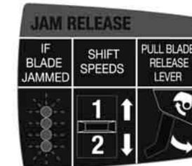
När skärknivarna klämmer fast blinkar alla 4 LED-lampor. Skjut reglaget fram och tillbaka mellan 1 och 2 och tryck knappen som är till för att öppna skärknivarna.
