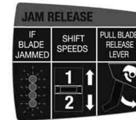
При блокиране на режещите ножове мигат всичките 4 LED светлини. Плъзнете плъзгачия се превключвател между позиция 1 и 2 и натиснете превключвателя за отваряне на режещите ножове.
