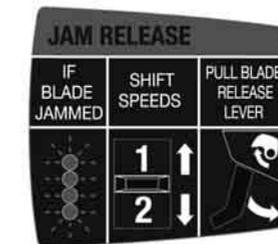
Kadar so rezalni noži zatakneni utripajo vse 4 LED. Dršno stikalo potiskajte med 1 in 2 sem ter tja in pritisnite tipko stikala za odpiranje rezalnih nožev.
