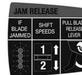
W przypadku zakleszczonych noży migają wszystkie 4 LEDy. Przesuwać przełącznik suwakowy pomiędzy położeniami 1 oraz 2 tam i z powrotem i nacisnąć przycisk przełącznika w celu otwarcia noży.
