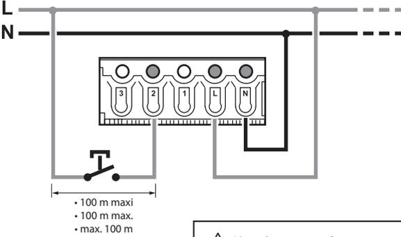
⚠ L'entrée commande 2 est configurable en interrupteur ou en bouton poussoir à l'aide de l'outil de configuration 0 882 30.
