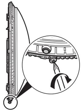
⚠ Pour clipper le hublot, appuyer sur bas de part et d'autres jusqu'aux 2 clics.
