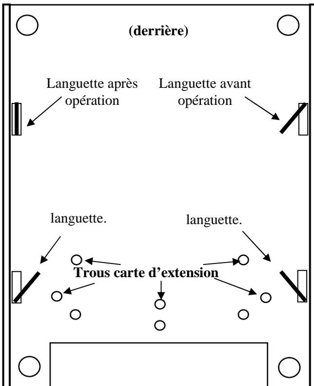
**Etape 4 :** retirer le support de la centrale, retourner l'embase inox, puis insérer les quatre clips de la carte d'extension dans les quatre trous de l'embase.
