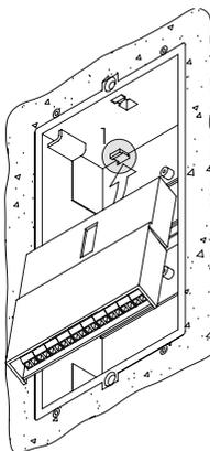
Ensuite, placer le module d'extension EL516SE. Pour ce faire, centrer l'orifice de la partie supérieure du couvercle du module d'extension avec celui du boîtier d'encastrement. Appuyer le circuit dans les supports inférieurs et fixer-le au moyen d'une vis.
