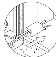
Connecter le groupe phonique au circuit microprocesseur EL500SE au moyen du câble plat fourni.
