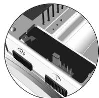
Le pontet de fin de ligne est placé sur le connecteur CN4, situé sur la partie arrière du moniteur. Dans le cas d'installations avec paire torsadée, le pontet de fin de ligne est placé sur le module EL562, situé aussi sur le connecteur CN4 (voir le détail précédent).
