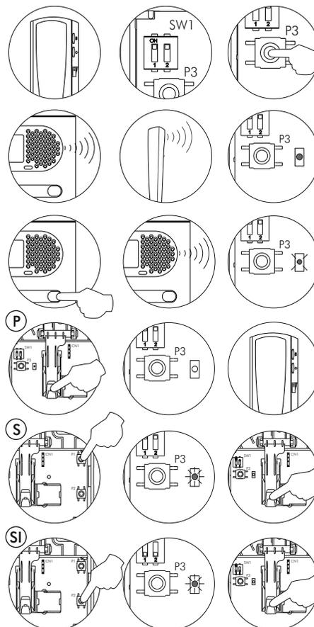
Ouvrir le poste à programmer (voir page 83). Sélectionnez dans le micro-interrupteur SW1 le mode fonction pour le poussoir de fonction (voir page 82) et ensuite presser le poussoir de programmation P3.
