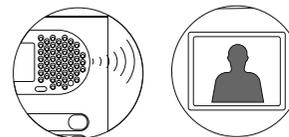
La plaque de rue émet un signal sonore et l'image apparaît sur le moniteur, indiquant que ce dernier peut être programmé. Relâcher le bouton de commande de gâche et décrocher le combiné pour établir communication.
