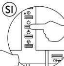
Pour programmer le moniteur comme **Principale**, presser le bouton d'allumage. Pour le programmer comme **Secondaire**, presser le bouton de commande de gâche. Pour le programmer comme **secondaire avec intercommunication**, presser le bouton
