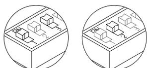
Localiser les micro-interrupteurs de configuration SW2 de la plaque générale à programmer, situés sur la partie centrale du circuit EL500SE. Avec les interrupteurs 1 et 3 à la position ON, placer l'interrupteur 2 en ON: la plaque générale émettra un ton indiquant qu'il est en mode programmation.
