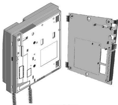
Placer le moniteur perpendiculairement à l'étrier et aligner les trous de fixation du moniteur avec les crochets de l'étrier de connexion, comme indiqué sur le dessin.
