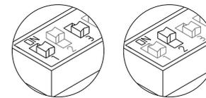
Localiser les micro-interrupteurs de configuration SW2 de la plaque générale à programmer, situés sur la partie centrale du circuit EL500SE. Avec les interrupteurs 1 et 3 à la position OFF, placer l'interrupteur 2 en ON: la plaque générale émettra un ton indiquant qu'il est en mode programmation.
