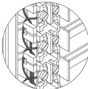
**TRÈS IMPORTANT:** Le commun des poussoirs d'un même module est réalisé à la fabrication. Câbler les communs des poussoirs de chaque module entre-eux. Le commun des poussoirs doit être connecté à la borne CP du circuit microprocesseur EL500SE ou à son module d'extension EL516SE (dans le cas où ces derniers existent).
