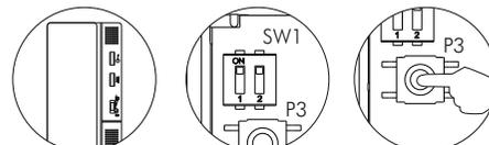
Ouvrir le poste à programmer (voir page 79). Sélectionnez dans le micro-interrupteur SW1 le mode fonction pour le poussoir de fonction (voir page 78) et ensuite presser le poussoir de programmation P3.
