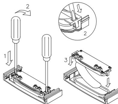
Avant de connecter le circuit du viseur (s'il existe) pour l'indication de canal occupé, se devra placer l'étiquette d'identification. Pour cela introduire un tournevis plat et faire un levier pour accéder à l'habitacle de l'étiquette. Une fois mise l'étiquette, placer le circuit.
