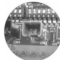
Le circuit le microprocesseur EL500SE est fourni par un câble avec connecteur pour l'indication de canal occupé.
