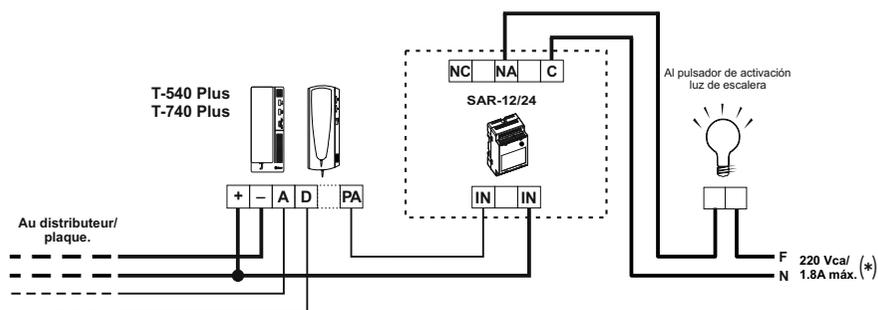
(\*) Le neutre d'alimentation de l'éclairage d'escalier est sérié à travers les contacts du relais SAR-12/24, le courant maximum permet pour l'éclairage d'escalier: 1.8A.
