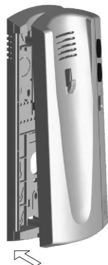
Passer les câbles par le trou prévu à cet effet, et les brancher à la réglette selon les schémas d'installation. Refermer le poste d'appel comme indiqué sur le dessin. Une fois le poste fermé, connecter le combiné au moyen du cordon téléphonique et le placer en position raccroché.
