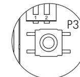
Le poussoir de programmation P3 est situé sur la partie gauche du circuit et sont accessibles ouvrant le poste d'appel. Permet au poste entrer en mode de programmation avec la plaque (Voir procès de programmation page 80).
