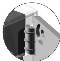
Fermer le moniteur comme un livre, en exerçant une légère pression sur la partie droite du moniteur jusqu'au 'clac' de fermeture.
