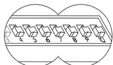
Définir le code de moniteur/poste d'appel à programmer à travers les microinterruptores SW2-4 a SW2-10. Placer un code entrez 1 et 120. La création d'un code se réalise en mode binaire, cf. page 65.
