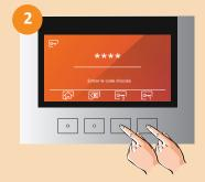
Taper le code d'accès et valider le code par «Porte 1» ou «Porte 2» (en fonction de la configuration)
