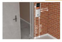
Pour être conforme avec la loi accessibilité, les systèmes de contrôle d'accès et de communication doivent être situés à une hauteur comprise entre 0,90 m et 1,30 m. Ils devront être également situés à plus de 0,40 m d'un angle rentrant de parois ou de tout autre obstacle à l'approche d'un fauteuil roulant.
