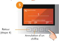
Entrer avec le clavier le code d'appel direct. Le code d'appel est configurable de 1 à 9999, c'est celui-ci que l'utilisateur va taper sur la platine à défilement pour appeler un appartement. Puis valider avec
