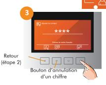
Utiliser le clavier pour ajouter un code d'accès et valider avec il est possible de ne pas ajouter de code en validant directement avec (nombre de terme 10 max)
