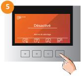
Activer ou désactiver l'alarme anti-sabotage(1) de la platine et valider
