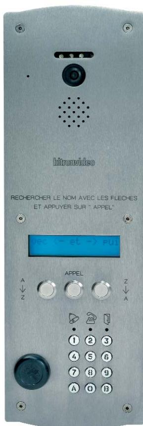
Compatible avec l'interphonie, quelle qu'elle soit, le contrôle d'accès permettra éventuellement de gérer les noms des résidents sur l'afficheur du défilement. Ici intégré sur une platine correspondant aux prescriptions de la loi «handicap», un lecteur de clé de proximité permet aux résidents d'entrer dans l'immeuble, il autorise aussi les prestataires de services porteurs d'un badge VIGIK® en cours de validité.
