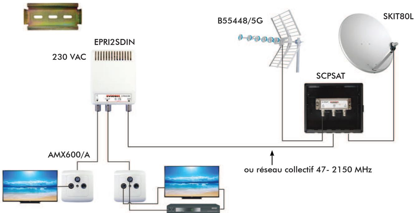
Dans le cas où la sortie F n'est pas utilisée, il est recommandé de mettre une charge 75 Ohms (AF59T).
