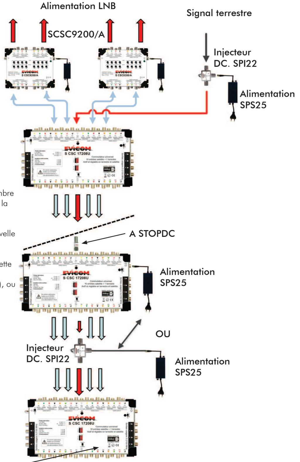
Dans le cas d'un trop grand nombre de commutateurs (+ de 9) et de la limite de consommation de la première alimentation, on peut remettre dans le réseau une nouvelle alimentation pour continuer à alimenter la ligne terrestre des commutateurs placés en aval. Cette alimentation peut se monter en colonne (sur le passage terrestre), ou se brancher sur le côté du commutateur (avec stop DC) **AU CHOIX**.
