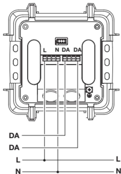
Die Netzzuleitung besteht aus einem 4 bis 5-adrigen Kabel:
