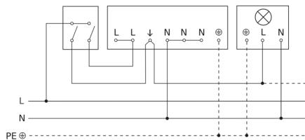
Schéma de câblage Raccordement via un commutateur pour l'éclairage permanent et le mode automatique
