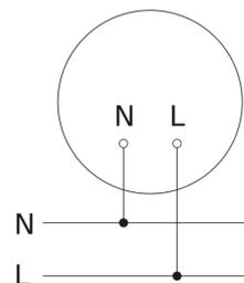
Schéma du circuit d'interconnexion maître/esclave
