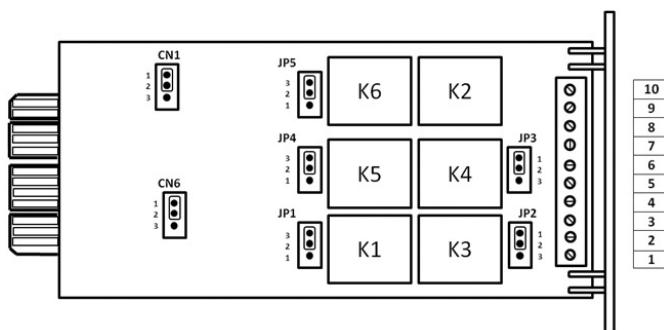
L'interfaccia è dotata di 6 relè (K), di 5 configurazioni jumper (JP) per la selezione del contatto normalmente aperto o normalmente chiuso dei contatti puliti e di 2 configurazioni jumper (CN) per la selezione della gestione dello spegnimento remoto dell'UPS.
