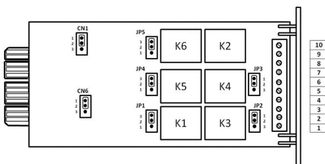
Die Relaiskarte ist mit 6 Relais (K), 5 Jumper-Konfigurationen (JP) zur Wahl des Arbeitskontakte oder Ruhekontakte der reinen Kontakte und mit 2 Jumper-Konfigurationen (CN) zur Wahl der Fernsteuerung zum Ausschalten der USV ausgestattet.
