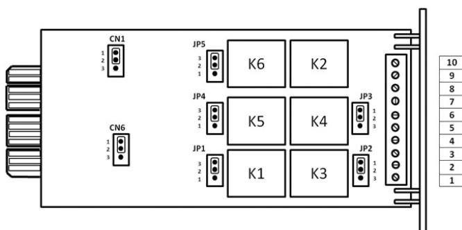
L'interface est dotée de 6 relais (K), de 5 configurations à cavaliers (JP) pour la sélection du contact normalement ouvert ou normalement fermé des contacts libres et de 2 configurations à cavaliers (CN) pour la sélection de la gestion de l'extinction à distance de l'UPS.
