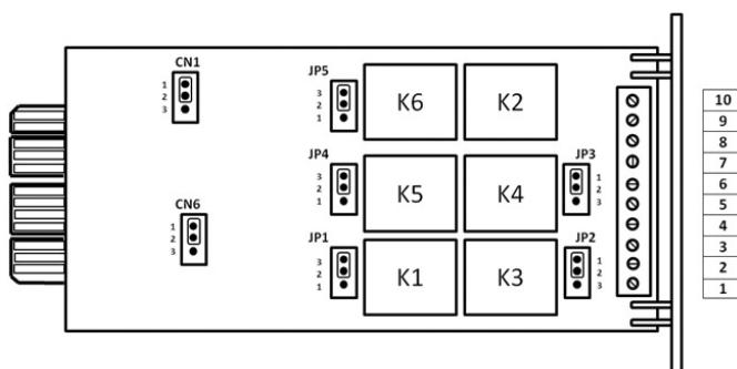
La interfaz presenta 6 relés (K), 5 configuraciones jumper (JP) para la selección del contacto normalmente abierto o normalmente cerrado de los contactos limpios y 2 configuraciones jumper (CN) para la selección de la gestión del apagado a distancia de la SAI.
