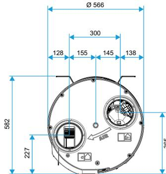
Encombrement T.Flow® Nano - Raccordement aéraulique
