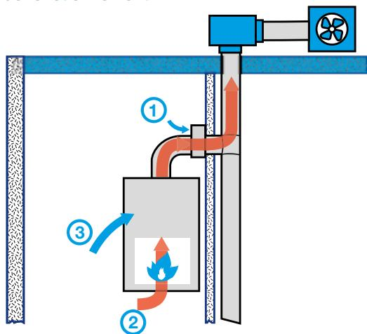
1. Brûleur éteint : le débit de base de ventilation ne passe pas par la chaudière, un orifice spécifique de la BAZ Pilot est utilisé, 2. Brûleur allumé : la bouche extrait un débit suffisant à travers la chaudière pour évacuer les gaz brûlés, 3. Quelque soit l'état du brûleur : un bouton poussoir permet d'extraire un débit de pointe de ventilation à travers la chaudière
