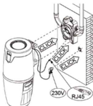
Schéma d'installation centrale C.Aspir® Comfort
