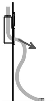
Installation de la prise à hauteur d'interrupteur
