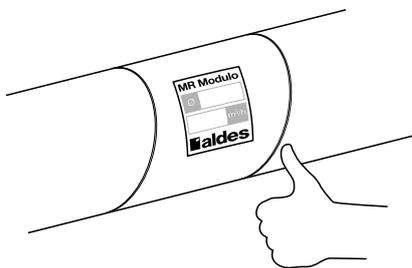
Pose de l'étiquette du MR Modulo sur le conduit
