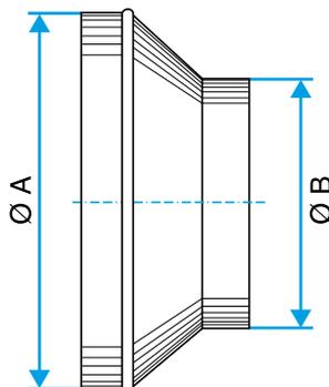
Schéma d'engrènement Réduction Conique Concentrique en aluminium
