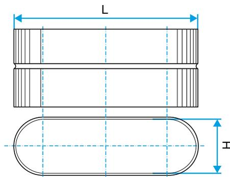
Schéma d'encombrement Raccord Femelle Oblong
