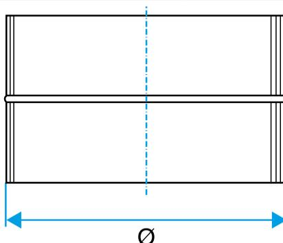
Schéma d'encadrement Raccord Mâle
