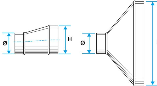
Schéma d'encombrement Réduction Oblongue Cylindrique Tangentielle sur Plat
