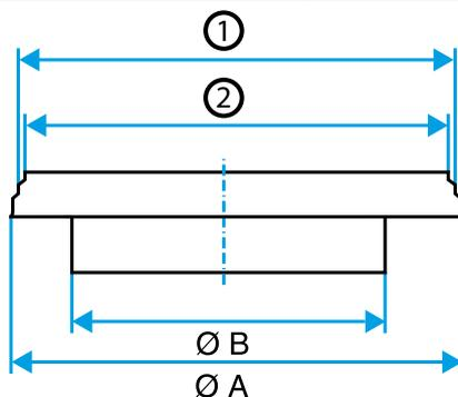
Schéma d'encombrement Réduction Plate Concentrique en aluminium
